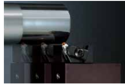
Opracování vnějšího povrchu
